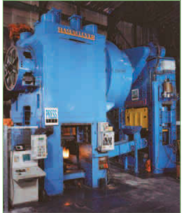
Komplett-Tuning einer 31,5 MN mechanischen Schmiedelinie
