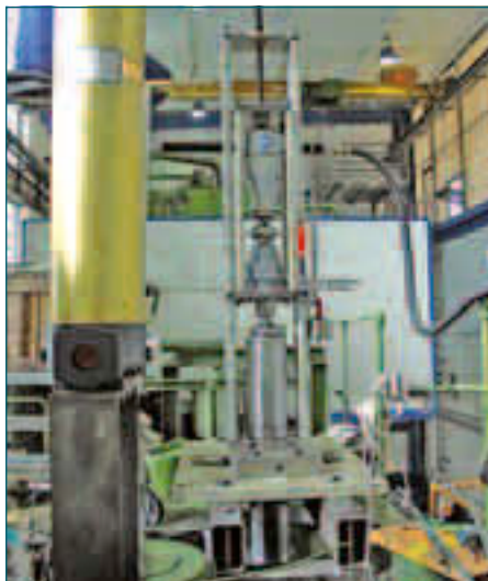
Montage der mobilen Zylinderausdrehvorrichtung an einer hydraulischen Dieffenbacher Presse.
