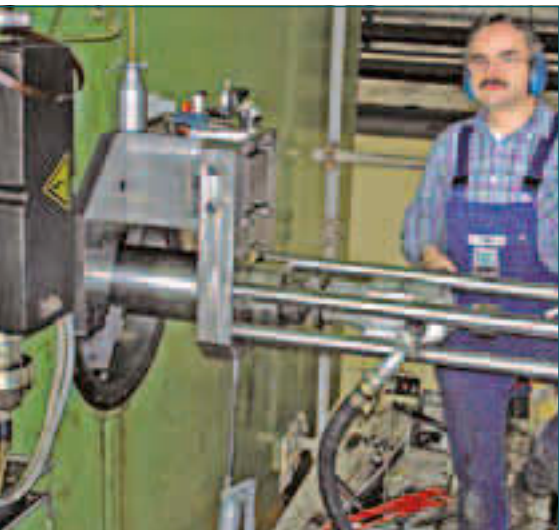
Justage der Ausspindelvorrichtung zur Pressengetriebebearbeitung.
