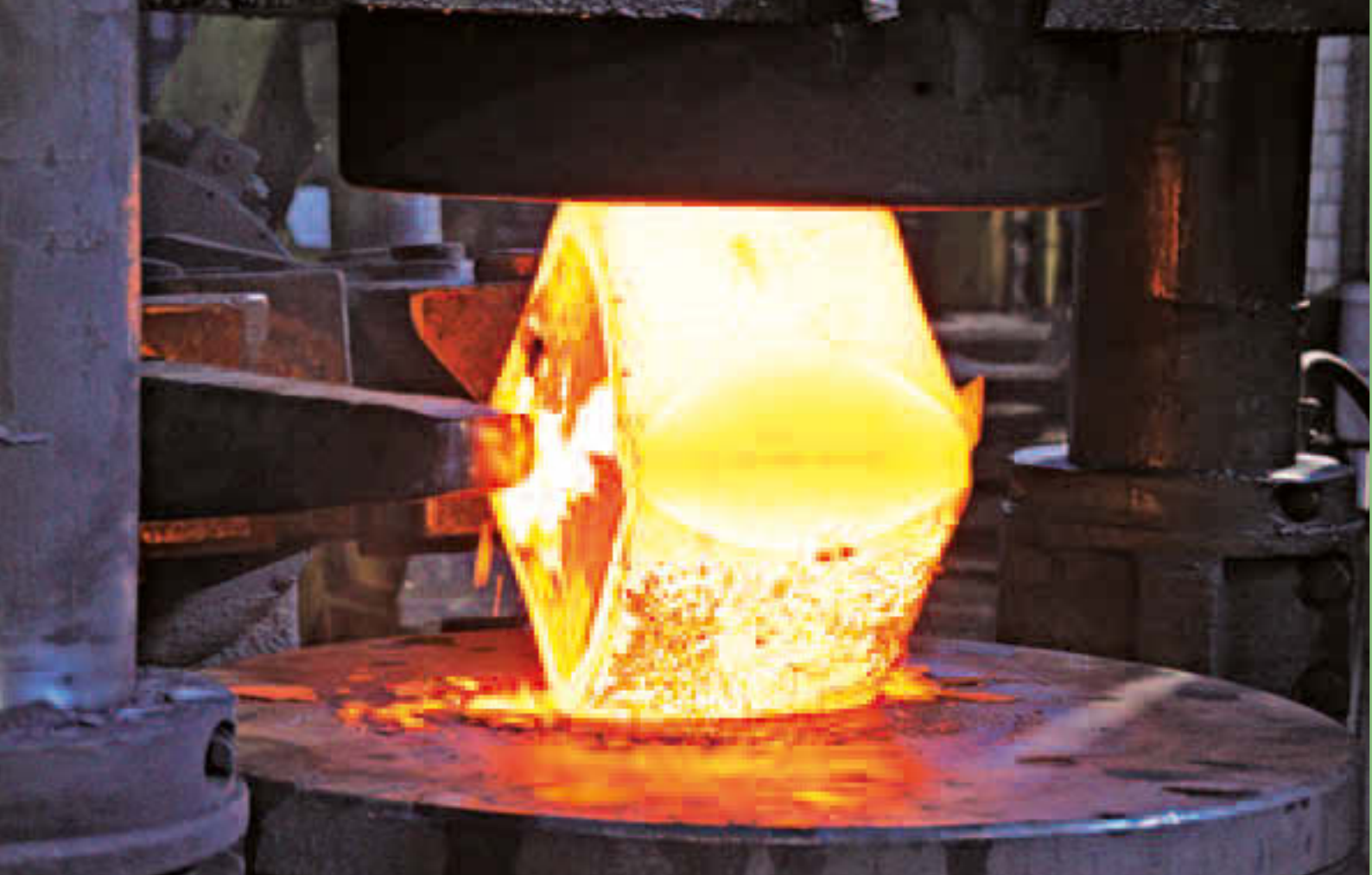
Die 10 MN-Pressen beim Schmieden Bilder: UMFÖRMTECHNIK
