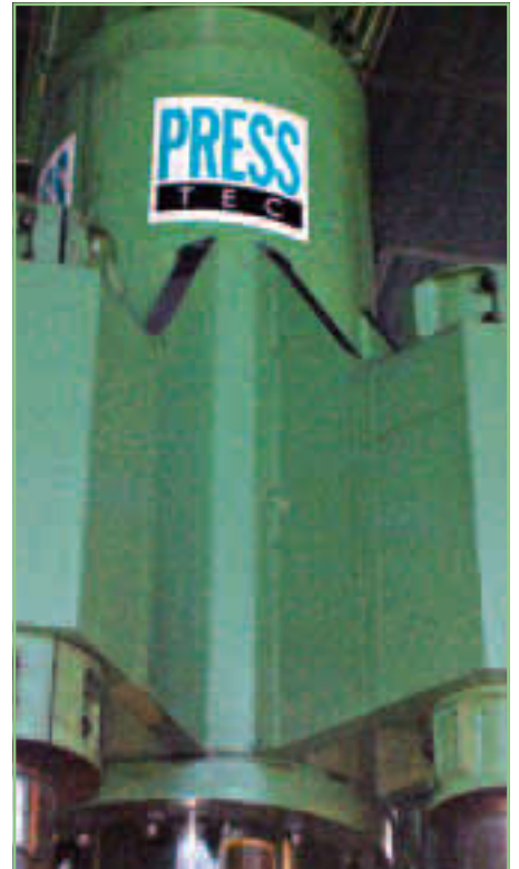
Der Pressenkopf wurde von Presstec als Schmiedekonstruktion ausgelegt
